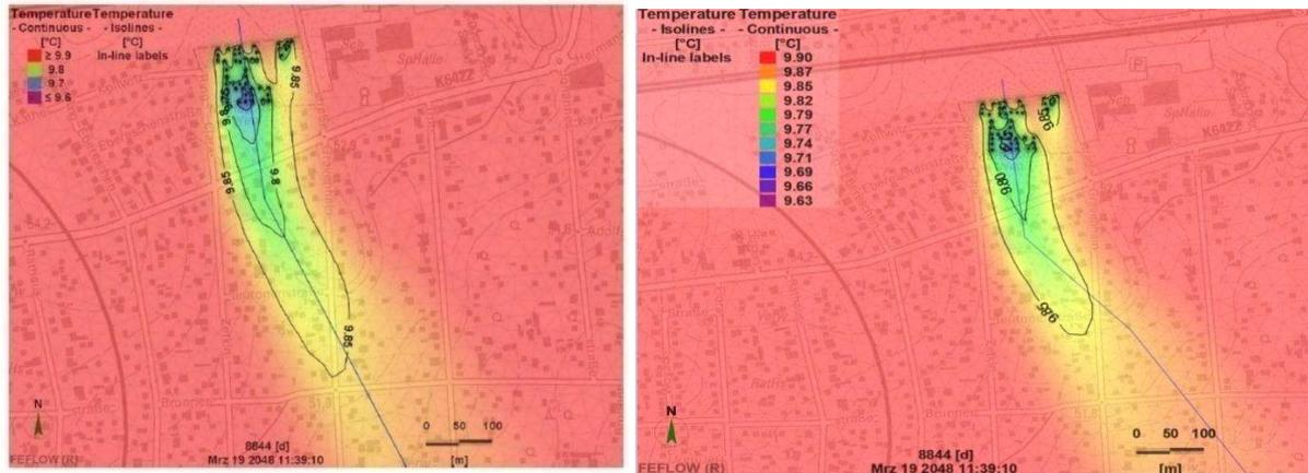
Abbildung 85: Simulation der Temperaturfahne an der Erdsonden-Anlage über die Laufzeit von 25 Jahren im Rahmen der Planung der Geothermieanlage (links) und mit den gemessenen Ist-Daten im EIPH-Projekt (rechts)
