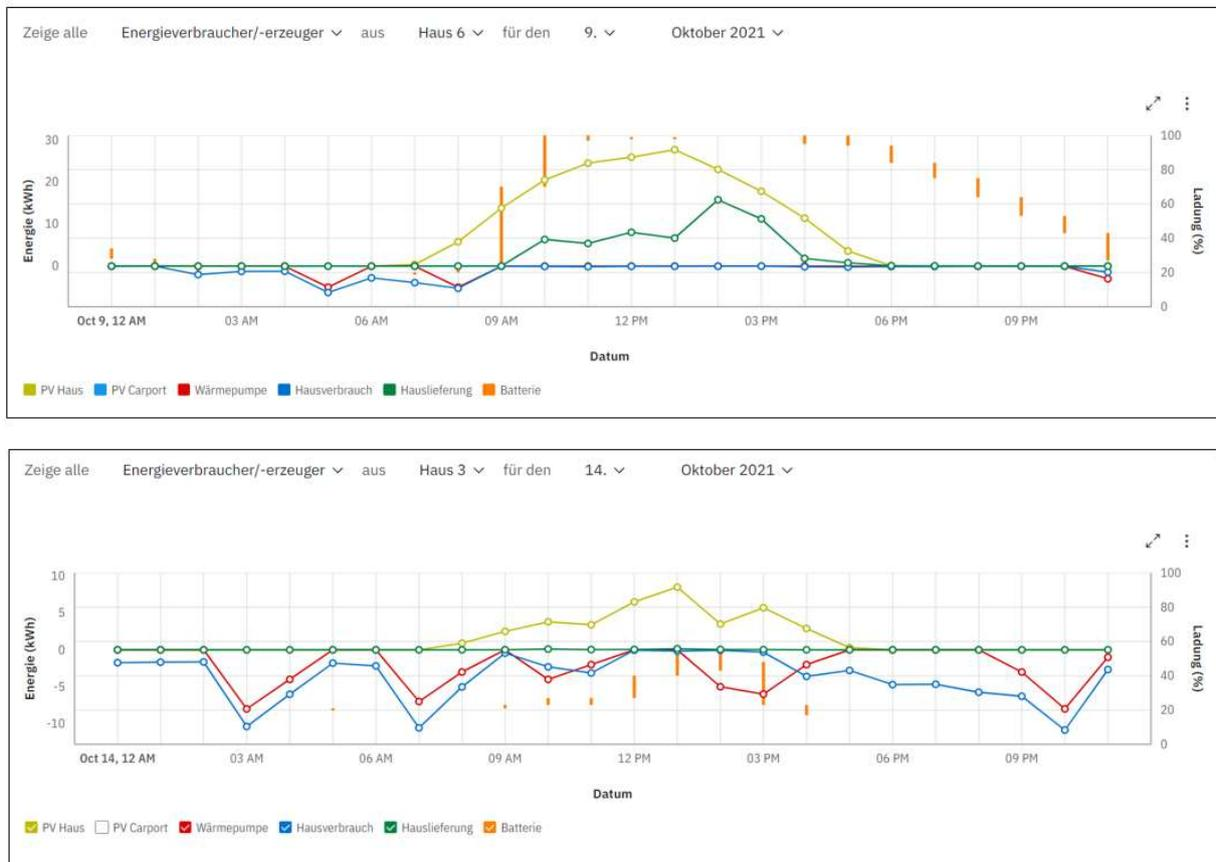
Abbildung 28: Vergleich der Energieflüsse an einem sonnenreichen (oben) und sonnenarmen Tag (unten) im Oktober bei aktiver Steuerung
